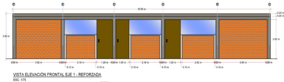
Figura 48 Elevación EJE 1 rigidizado con muros de 25 cm
